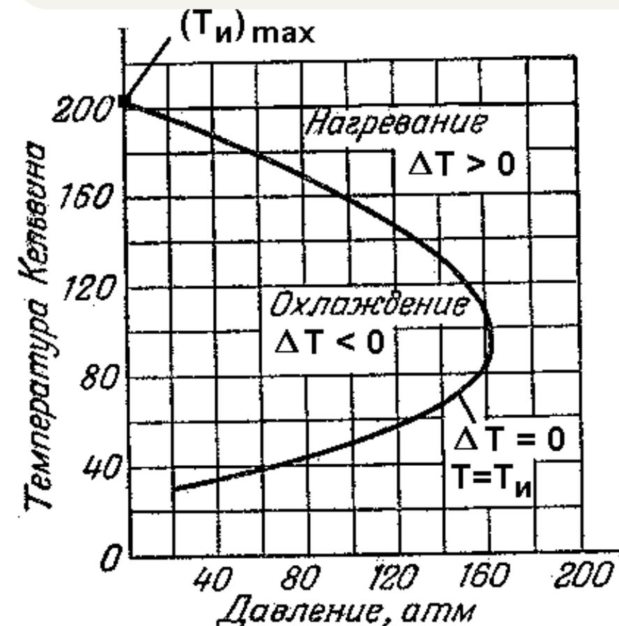
При температуре опыта  $T < T_i$  дифференциальный эффект положителен  $(\partial T / \partial p)_H > 0$ , то есть при просачивании газа в область с меньшим давлением его температура понижается. И наоборот, при температуре опыта  $T > T_i$  эффект Джоуля – Томсона отрицателен  $(\partial T / \partial p)_H < 0$ , то есть в процессе дросселирования температура газа повышается.
