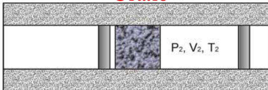
1. Между газами в объемах  $V_1$  и  $V_2$  отсутствует прямой теплообмен через пористую перегородку, которая делается из материала с достаточно низкой теплопроводностью.
