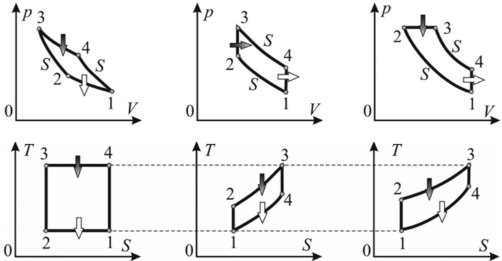
Графическое сравнение цикла Карно (а) с циклами Отто (б) и Дизеля (в), заданными на р-В и Т-С диаграммах.
