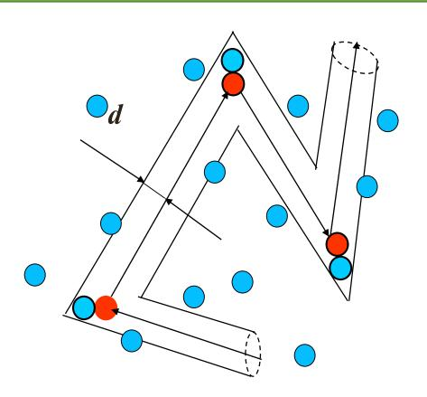
Расстояние, проходимое молекулой между двумя последовательными столкновениями называется длиной свободного пробега.
