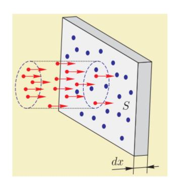
Пусть на слой рассеивающей среды площадью сечения S толщиной dx, падает поток частиц. В этом слое находится dN = nSdx, рассеивающих частиц среды (n — концентрация).
