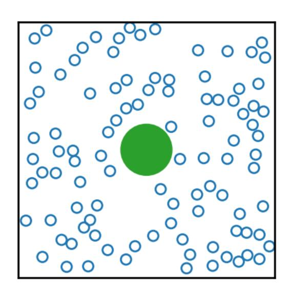
В 1827 г. английский ботаник Р. Броун наблюдал в микроскоп с сильным увеличением беспорядочное движение субмикронных частиц (спор семян), взвешенных в воде. Интенсивность броуновского движения увеличивалась с ростом температуры среды и с уменьшением ее вязкости и размеров частиц.
