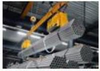
Электромагниты, обладающие большой подъемной силой, используют на заводах для зереноски наделять из стали или чугуна
