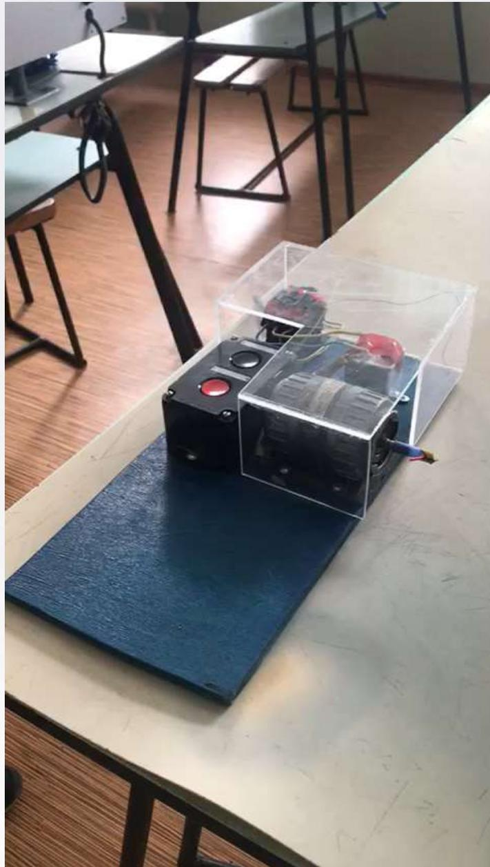
В данном видео показана автоматизированная система поднятия вёдер со дна колодца при помощи асинхронного трёхфазного двигателя.
