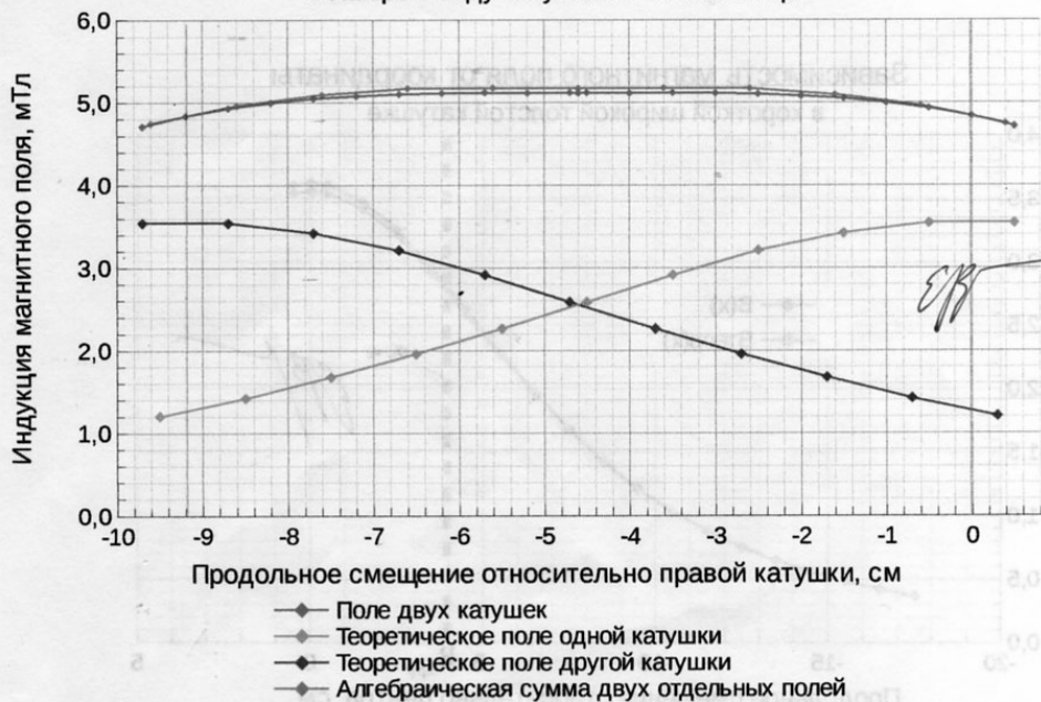
Зависимость магнитного поля от координаты в зазоре между катушками Гельмгольца
