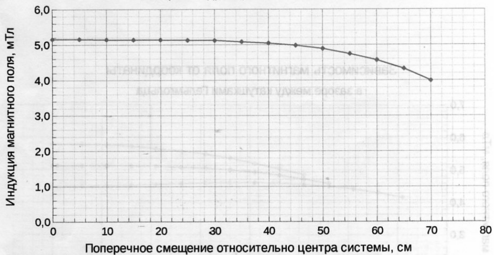
Зависимость магнитного поля от координаты в зазоре между катушками Гельмгольца
