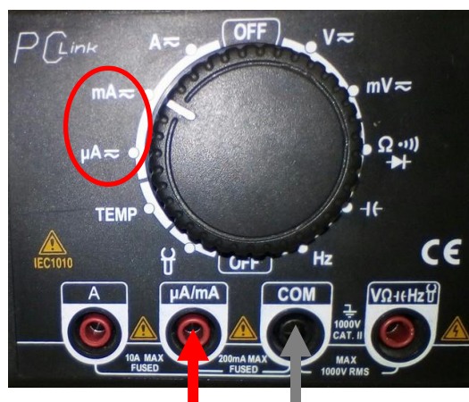
Рис. 7.16. Подключение мультиметра MS8040 в режиме измерения постоянного тока.
