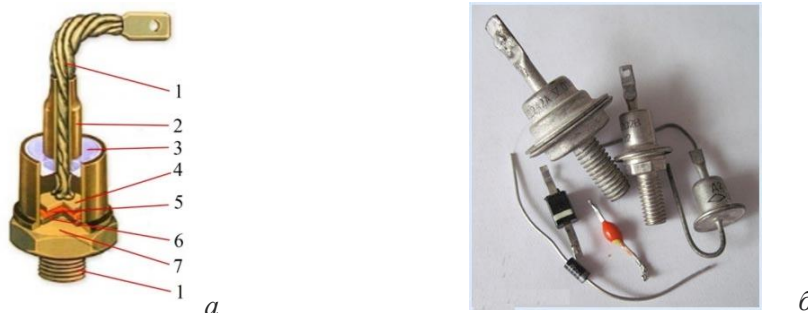
Рис. 7.4. Устройство ( a ) и внешний вид некоторых типов диодов ( б ): 1-выводы, 2- корпус, 3- стеклянный изолятор, 4-контактная пластина, 5- пластина индия, 6-пластина кремния (или германия), 7- основание.
