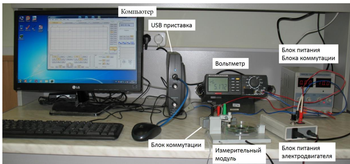
Рис. 15. Внешний вид установки для измерения угловой скорости вала электромотора.
