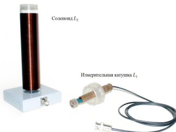
Рис.6. Основные элементы установки для измерения переменного магнитного поля индукционным методом.
