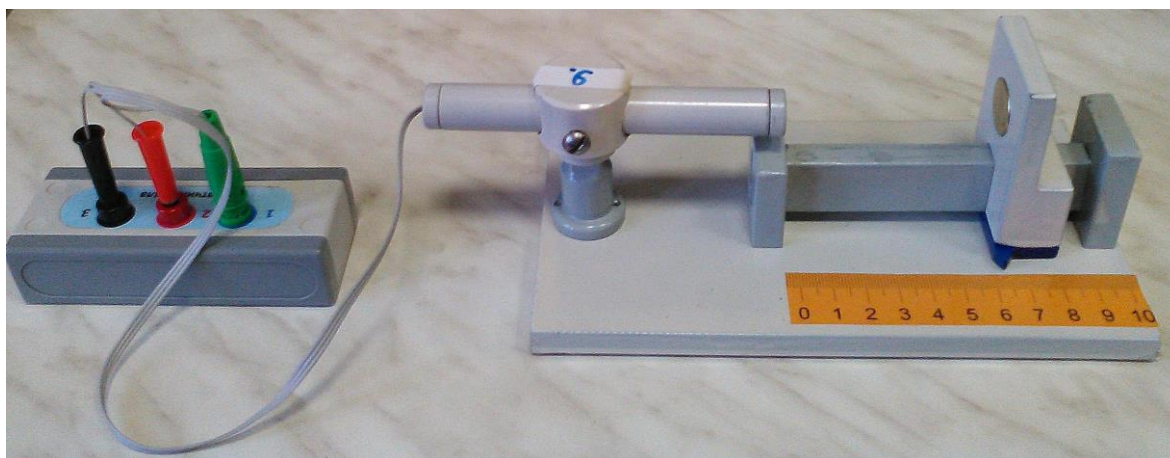
Рис. 3. Установка для градуировки датчика Холла.
