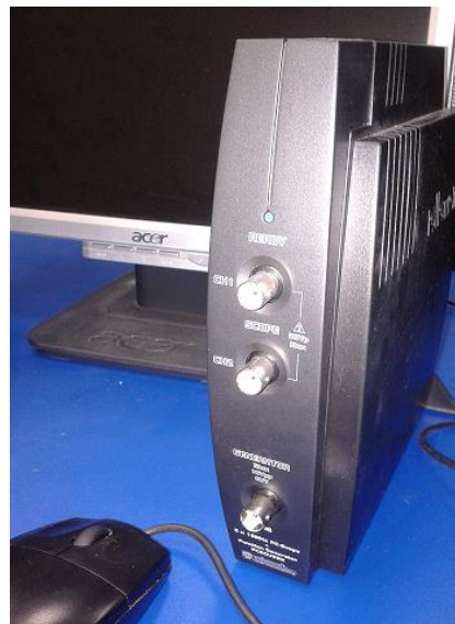
Рис. 5.5. Осциллографическая приставка к компьютеру PCSGU250.
