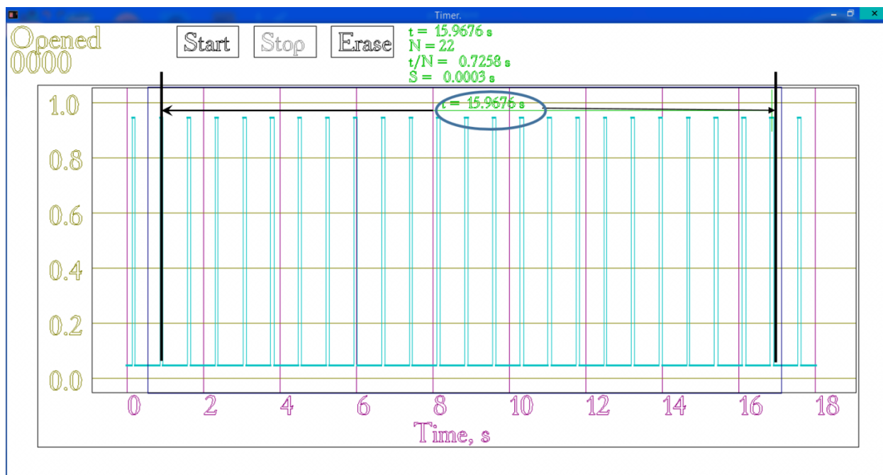
Рис. 2. Главное окно программы управления фотоэлектрическим датчиком.
