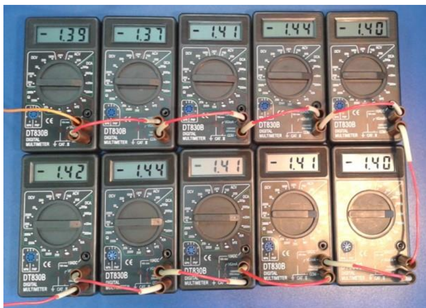
Рис. 9. Показания амперметров, соединенных последовательно (т.е. измеряющих один и тот же ток).
