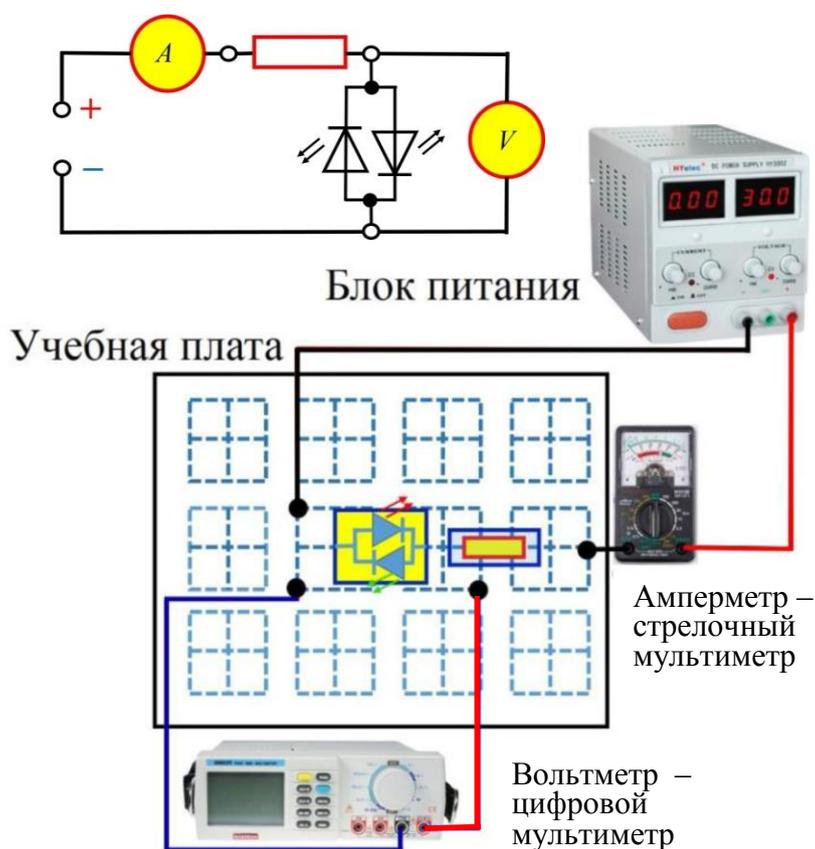
Рис. 13. Электрическая схема и блок-схема соединения элементов для измерения ВАХ светодиодов.
