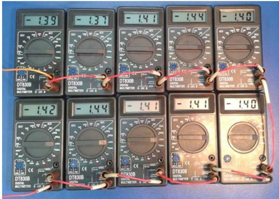
Рис. 9. Показания амперметров, соединенных последовательно (т.е. измеряющих один и тот же ток).
