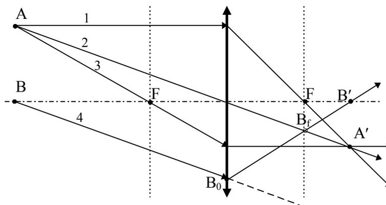
Рис. 2. Построение изображения в случае собирающей линзы.
