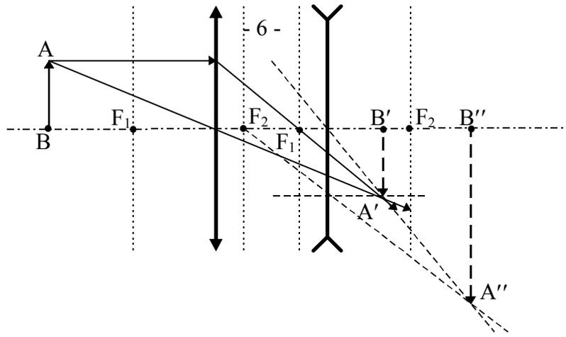
Рис.5. Построение изображения для оптической системы, состоящей из собирающей и рассеивающей линз:
