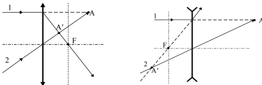
Рис 4. Построение изображения в случае мнимого источника для собирающей и рассеивающей линз:
