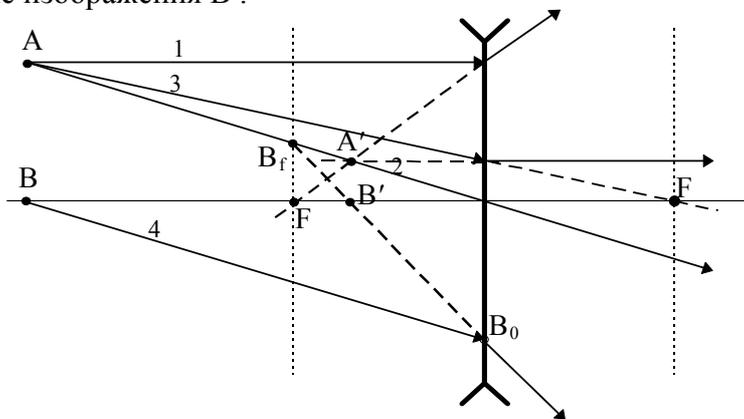
Рис.3. Построение изображения в случае рассеивающей линзы.
