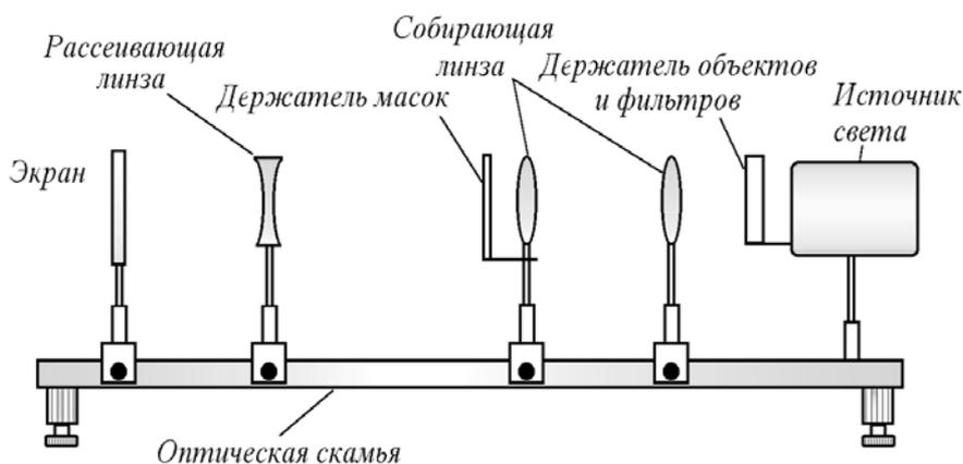
Рис.8. Схема экспериментальной установки
