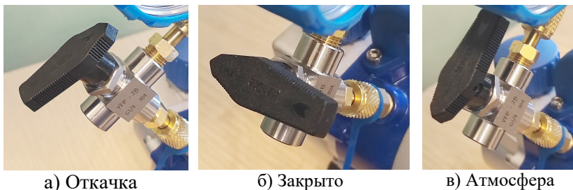
Рис.9 Положения ручки вакуумного крана
