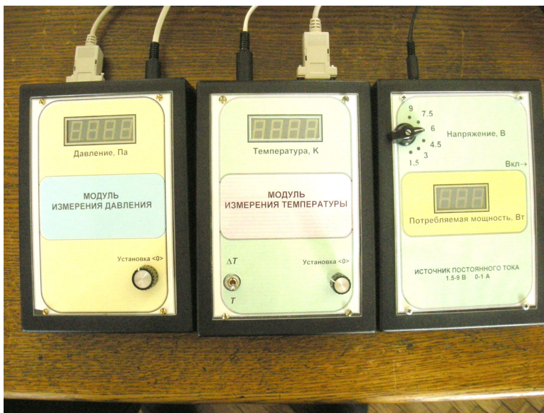
Рис.5. Модули измерения давления, температуры и регулируемый блок питания нагревателя с индикатором мощности.
