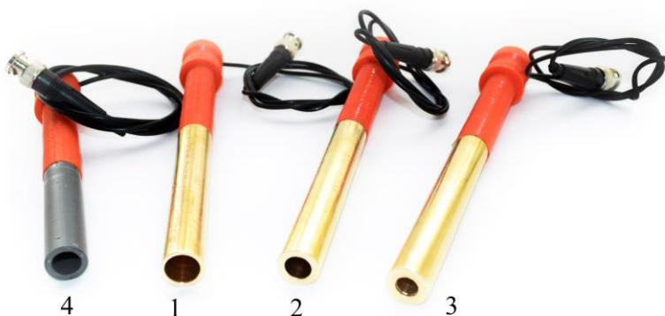
Рис. 9. Измерительные катушки с экраном из латуни (1 – 3) и из пластика (4).
