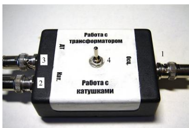
Рис. 10. Внешний вид коммутатора: 1 – подключение к USB приставки (Ch1), 2 – подключение измерительной катушки, 3 – подключение дифференциального трансформатора, 3 – переключатель режимов работы с измерительной катушкой или с дифференциальным трансформатором.
