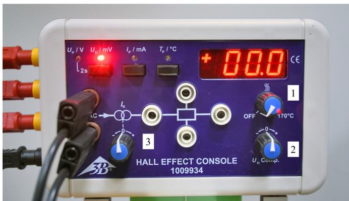
Рис. 5.12. Регуляторы измерительного модуля: 1 – регулятор нагрева; 2 – регулятор калировки напряжения Холла « $U_H$  Comp»; 3 – регулятор силы тока  $I_p$  через полупроводниковый образец.
