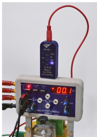
Рис. 5.11. Измерительный модуль с установленным датчиком магнитного поля.
