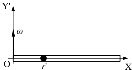
Рис. 10.6. Вращающаяся горизонтальная трубка и оси неинерциальной системы отсчета.
