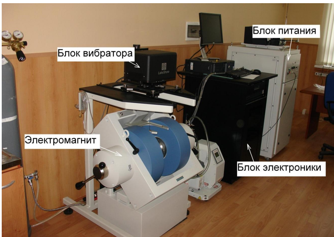
Рисунок 10– Общий вид вибрационного магнитометра Lake Share.
