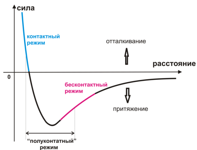
Рис. 3.4. График зависимости силы Ван-дер-Ваальса от расстояния между кантилевером и поверхностью
