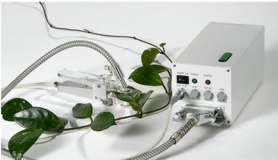
Рис. 7. Внешний вид импульсного флуориметра PAM-2500.
