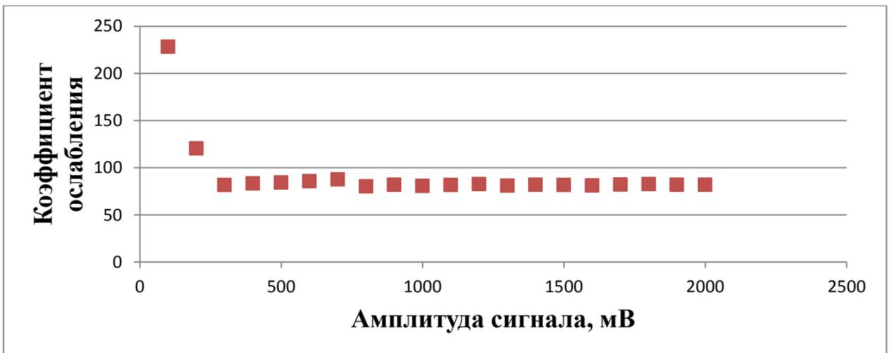
**Рис. 8. Коэффициент ослабления сигнала при различных значениях амплитуды сигнала.**
