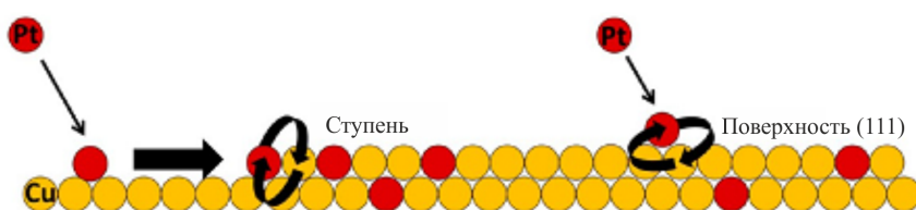
Рис. 3: Предполагаемый механизм образования поверхностного сплава Pt/Cu(111).
