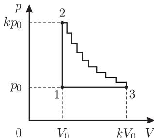
Найдите КПД тепловой машины, работающей по данному циклу.
