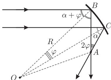
Лучи  $CA$  и  $BA$  пересекаются в точке  $A$ , где получается «изображение» источника звука. В этой точке колебания складываются, интенсивность звука максимальна — там и должен располагаться микрофон.
