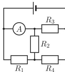
**Решение.** Поскольку амперметр можно считать идеальным, падение напряжения на нём равно нулю. Поэтому на резисторе  $R_3$  падает напряжение  $U_3 = U$ . Следовательно, сила тока, текущего через этот резистор, равна  $I_3 = U_3/R_3 = U/R_3 = 0,15 \text{ А}$ . Далее, сила тока  $I$ , текущего через амперметр, равна сумме сил токов  $I_2$  и  $I_3$ ; отсюда  $I_2 = I - I_3 = I - (U/R_3) = 0,035 \text{ А}$ .
