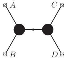
**Решение.** Примем, что потенциал электрического поля в средней точке, лежащей на проводнике, который соединяет «чёрные ящики», равен нулю. Так как исследуемая электрическая схема состоит только из элементов, для которых справедлив закон Ома, то потенциалы  $\varphi_A$  клеммы  $A$  и  $\varphi_B$  клеммы  $B$  должны линейно зависеть от сил токов  $I_A$  и  $I_B$ , протекающих через эти клеммы при подключении к ним омметра:
