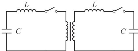
один из конденсаторов и замкнуть ключ, подсоединяющий его к трансформатору, в цепи возникнут гармонические колебания с частотой  $\omega$ . Найдите возможные частоты гармонических электрических колебаний в цепи, если оба ключа замкнуты.
