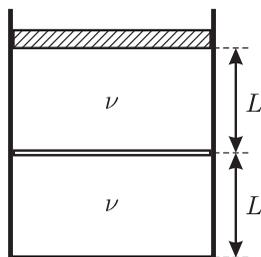
сосуда имели высоту  $L$ . Потом систему медленно нагрели, сообщив ей количество теплоты  $\Delta Q$ . На какую величину  $\Delta T$  изменилась температура газов, если нижний поршень при этом не сдвинулся с места? При каком наименьшем значении  $F$  силы трения между нижним поршнем и стенками это возможно? Какова теплоёмкость  $C$  системы в этом процессе? Теплоёмкостью стенок сосуда и поршней пренебречь.
