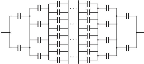
Ёмкость получившейся эквивалентной цепи также может быть найдена при помощи законов последовательного и параллельного соединения конденсаторов:
