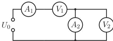
**Решение.** Сила тока, текущего через вольтметр  $V_1$ , больше силы тока, текущего через вольтметр  $V_2$ , следовательно, показание вольтметра  $V_1$  больше показания вольтметра  $V_2$ . При этом сила тока, текущего через вольтметр  $V_2$ , меньше силы тока, текущего через вольтметр  $V_1$ , в  $U/U' = 4$  раза и составляет  $I_1 U'/U = I_1/4 = 0,4$  мА.
