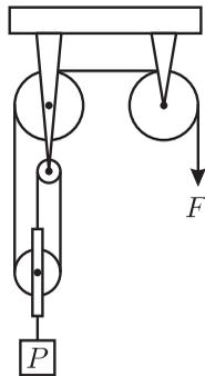
**Решение.** Ввиду невесомости блоков и троса и отсутствия трения сила натяжения троса равна  $F$  в любой его части. К нижнему блоку приложены три силы  $F$ , направленные вверх, и одна сила  $P$ , направленная вниз. Поскольку этот блок находится в равновесии или медленно и равномерно поднимается, то  $P = 3F$ , а  $F = P/3$ .
