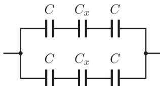
каждая из половин цепи имеет ёмкость  $\frac{C_x \cdot C/2}{C_x + (C/2)}$ , а ёмкость всей цепи в 2 раза больше. Следовательно,
