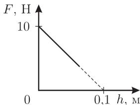
**Решение.** Как следует из графика, сила  $F$  является линейной функцией глубины погружения  $h$ :
