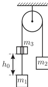
**Решение.** Рассмотрим движение грузов до момента их столкновения с шайбой из пластилина. Пусть  $T$  — сила натяжения нити,  $a_0$  — направленное вниз ускорение груза  $m_2$ . В силу нерастяжимости нити это ускорение равно по величине и противоположно по направлению ускорению груза  $m_1$ . Запишем уравнения движения для грузов  $m_1$  и  $m_2$  в проекции на вертикальную ось, направленную вниз:
